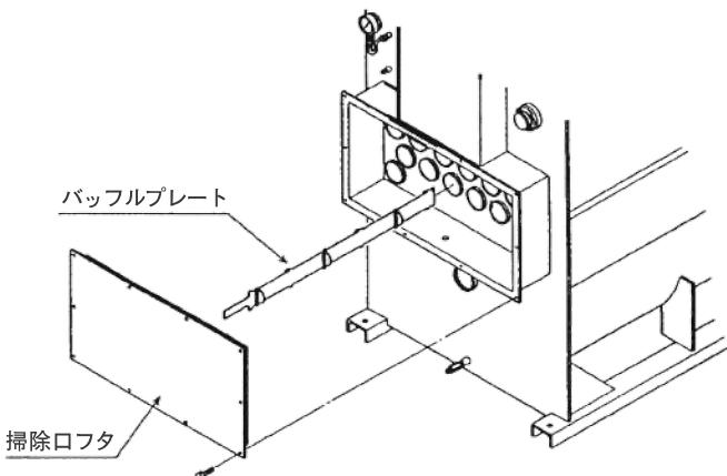
※水洗に使用した水は火室下部に溜りますので、水抜口プラグ（15A）を取り外して、排水ホース等を接続すると便利です。ある程度排水できましたら、スポンジ、ウェス等を用いて水分を除去してください。掃除が終わったらバッフルプレート、掃除口フタ、バーナー耐火材などを元通り取付けてください。
