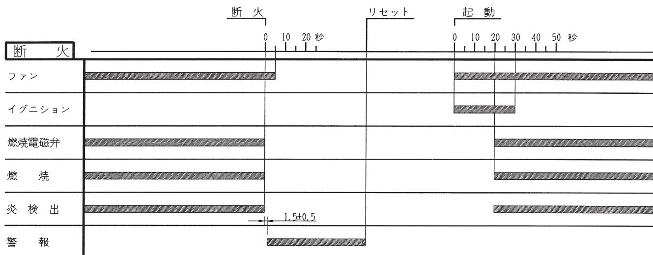
●バーナー型式 RL-50L、70L (ローファイヤースタートON-OFF制御)
