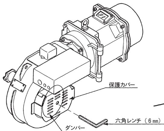
保護カバーの中心穴に六角レンチ（6 mm）を差し込み、ダンパー止めネジをゆるめ、ダンパーを開又は閉方向に回して調整してください。調整後は止めネジを確実に締め付けてください。
