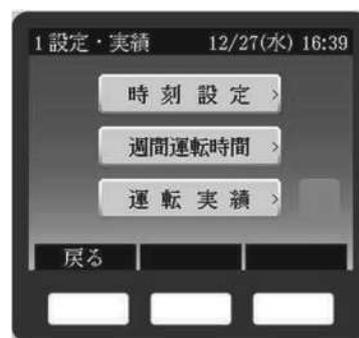
もう一度【左】スイッチ(戻る)を押すと、設定温度と缶水温度の表示画面に戻ります。(操作しない場合でもしばらくすると自動的に戻ります。)
