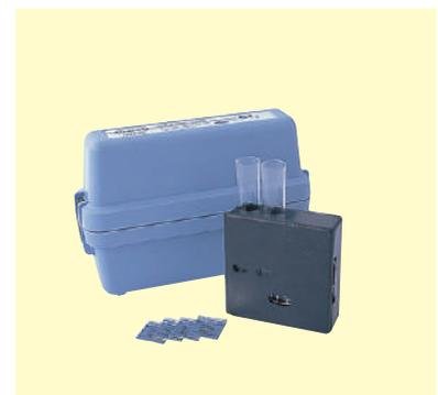
残留塩素の測定に使用します。残留塩素を含む水にDPD粉末試薬を加えると残留塩素の量に応じて淡赤紫色を呈する反応に基づく方法です。
