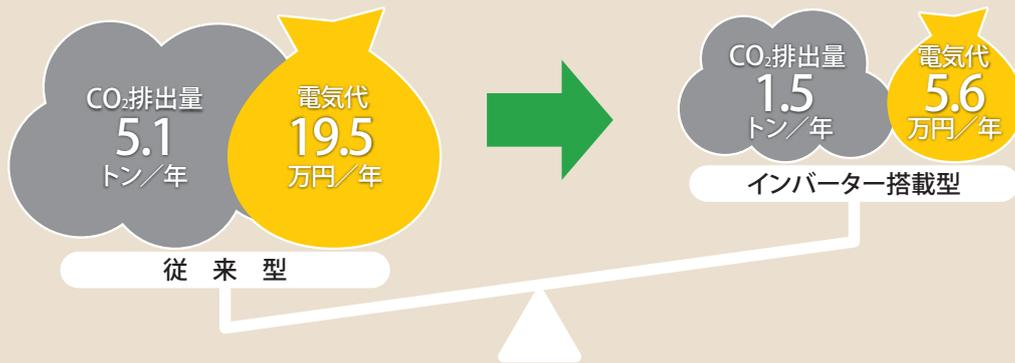
※上記削減値は、定格処理量12m<sup>3</sup>/h、ろ過ポンプ1.5kWで試算し、24時間定格運転の場合と、16時間定格運転+8時間省エネモード運転の場合を比較したものです。
