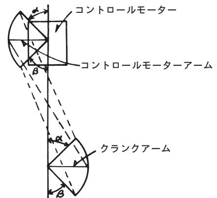
（図2）コントロールモーターのリンク
