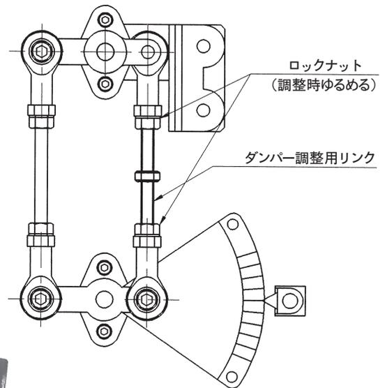
⚠ダンパー調整用リンクをゆるめすぎるとリンクがダンパーから外れますので注意してください。
