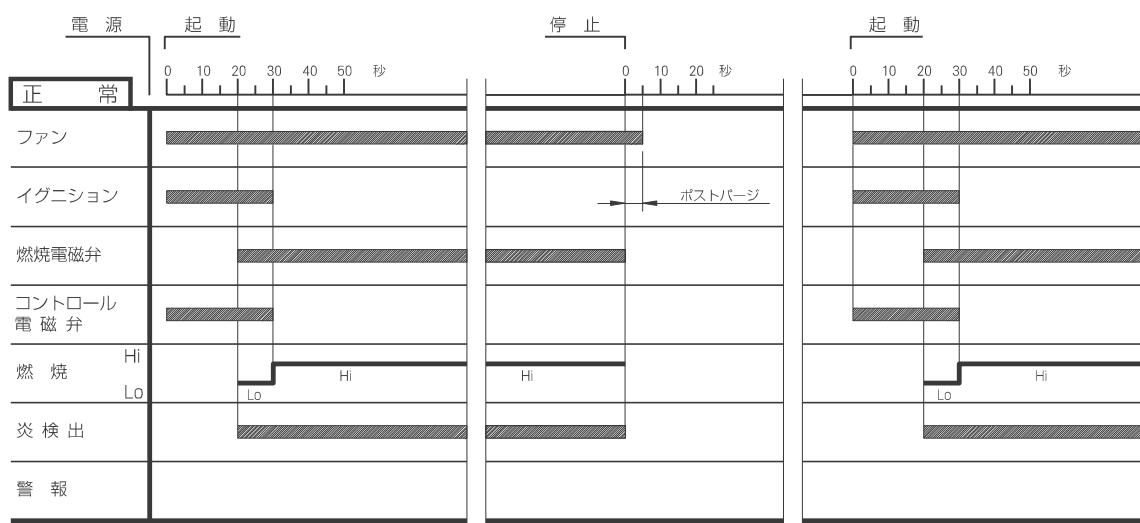
4) 不着火又は断火が発生した場合はコントローラーの安全装置が働き、直ちに燃焼電磁弁を閉止し警報を発します。(警報ブザーは中スイッチ(ブザー停止)を押すと止まります。) エラー内容・シーケンス内容を記録し、その原因を除去して右スイッチ(リセット)を押してください。再度運転する場合は運転／停止スイッチを押してください。
