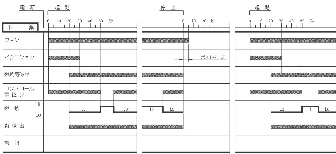
4) 不着火又は断火が発生した場合はコントローラーの安全装置が働き、直ちに燃焼電磁弁を閉止し警報を発します。(警報ブザーは中スイッチ(ブザー停止)を押すと止まります。) エラー内容・シーケンス内容を記録し、その原因を除去して右スイッチ(リセット)を押してください。再度運転する場合は運転／停止スイッチを押してください。
