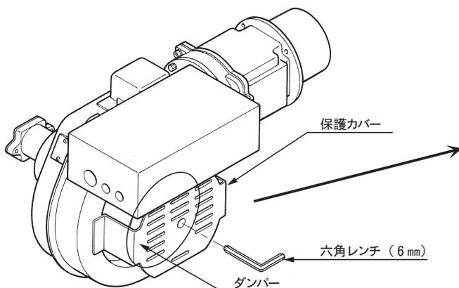
保護カバーの中心穴に六角レンチ（6mm）を差し込み、ダンパー止めネジをゆるめ、ダンパーを開又は閉方向に回して調整してください。調整後は止めネジを確実に締め付けてください。
