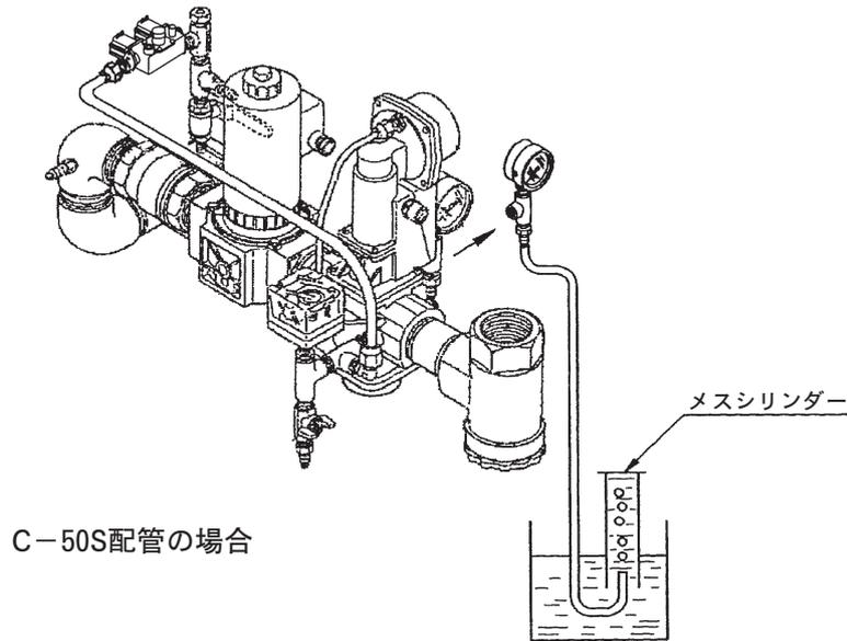
2) 下流側遮断弁の通り抜け
