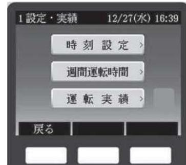
もう一度【左】スイッチ(戻る)を押すと、設定温度と缶水温度の表示画面に戻ります。(操作しない場合でもしばらくすると自動的に戻ります。)
