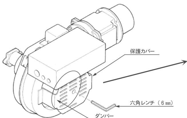
保護カバーの中心穴に六角レンチ（6 mm）を差し込み、ダンパー止めねじをゆるめ、ダンパーを開又は閉方向に回して調整してください。調整後は止めねじを確実に締め付けてください。
