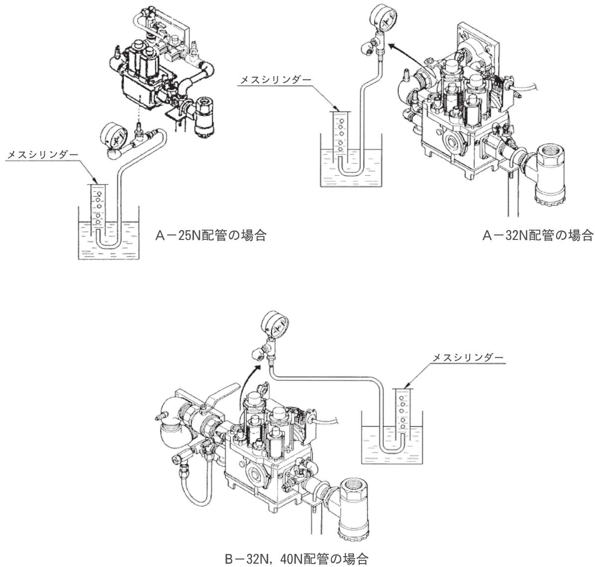
2) 下流側遮断弁の通り抜け
