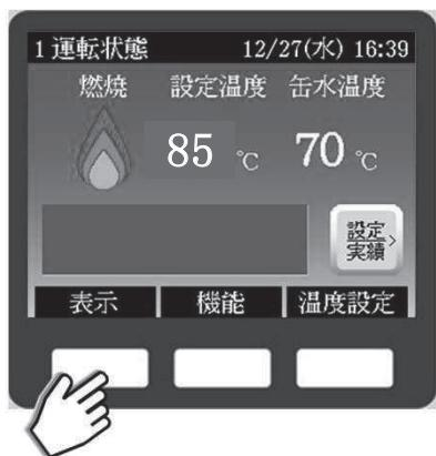
2 )設定温度を変更する回路の温度を押すと、温度表示が黄色に変わります。
