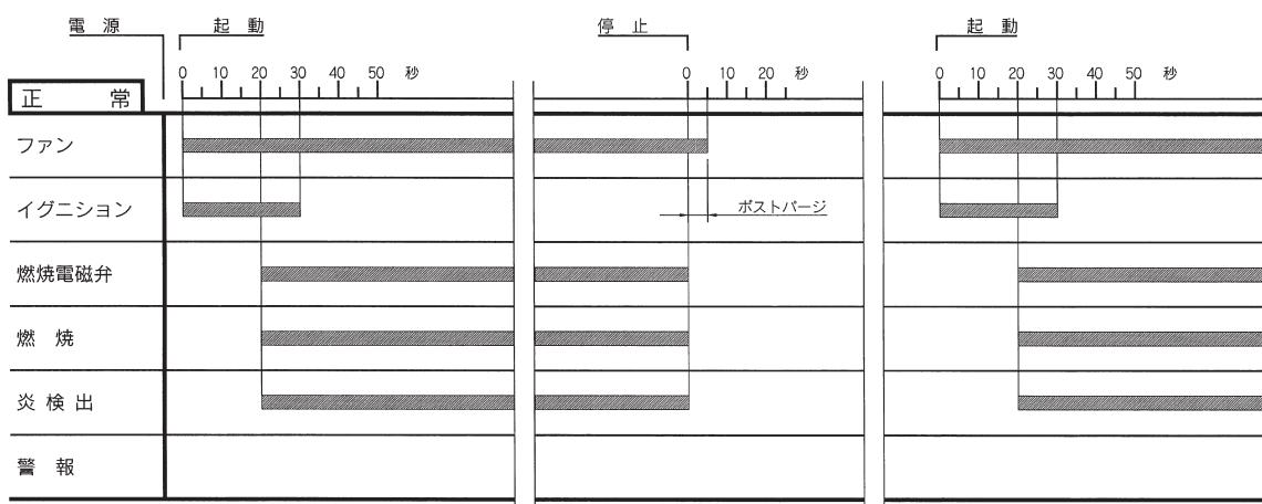
4) 不着火又は断火が発生した場合はコントローラーの安全装置が働き、直ちに燃焼電磁弁を閉止し警報を発します。(警報ブザーは中スイッチ(ブザー停止)を押すと止まります。) エラー内容・シーケンス内容を記録し、その原因を除去して右スイッチ(リセット)を押してください。再度運転する場合は運転／停止スイッチを押してください。
