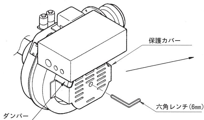
保護カバーの中心穴に六角レンチ（6 mm）を差し込み、ダンパー止めねじをゆるめ、ダンパーを開又は閉方向に回して調整してください。調整後は止めねじを確実に締め付けてください。
