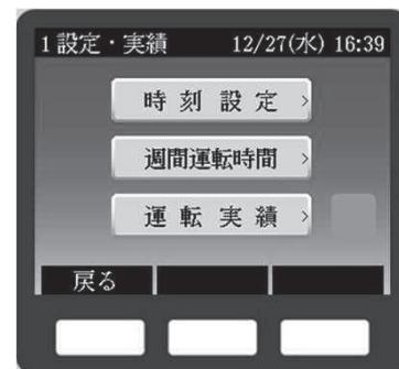
もう一度【左】スイッチ(戻る)を押すと、設定温度と游水温度の表示画面に戻ります。(操作しない場合でもしばらくすると自動的に戻ります。)
