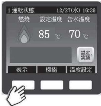
2) 設定温度を変更する回路の温度を押すと、温度表示が黄色になります。
