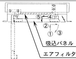
2. エアフィルタの汚れを電気掃除機で落とすか、水又は中性洗剤で洗い流してください。
