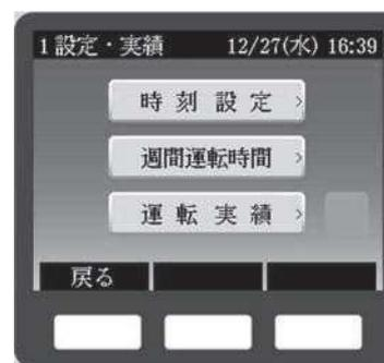
もう一度【左】スイッチ（戻る）を押すと、設定温度と缶水温度の表示画面に戻ります。
