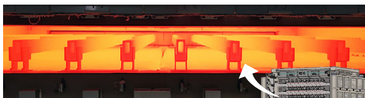
加熱中の炉内部の様子。最高使用温度は1000℃。耐久性にも優れる。
