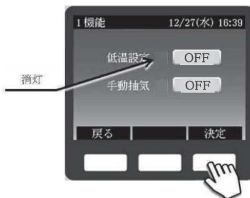
5) 設定温度と缶水温度の表示画面に戻る場合は、【左】スイッチ(戻る)を押してください。
