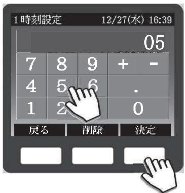
5) 日付および時刻を入力したら、[右]スイッチ(決定)を押すと、設定が完了します。
