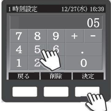
5) 日付および時刻を入力したら、【右】スイッチ(決定)を押すと、設定が完了します。
