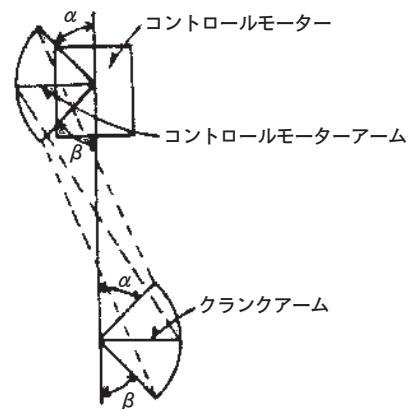
(図-2) コントロールモーターのリンク
