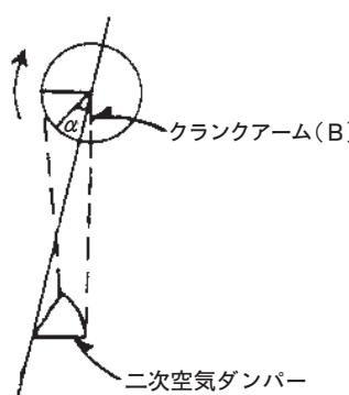
(図-4) 二次空気ダンパーのリンク
