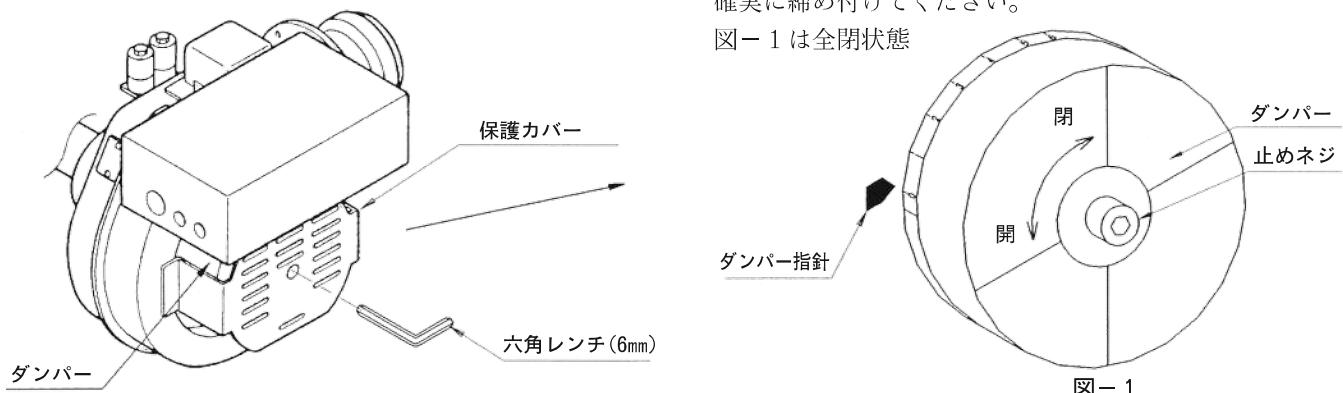
2) RL-40L・50L型 (LoファイヤースタートON-OFF制御)、RL-70H型 (Hi-Lo-OFF制御)
