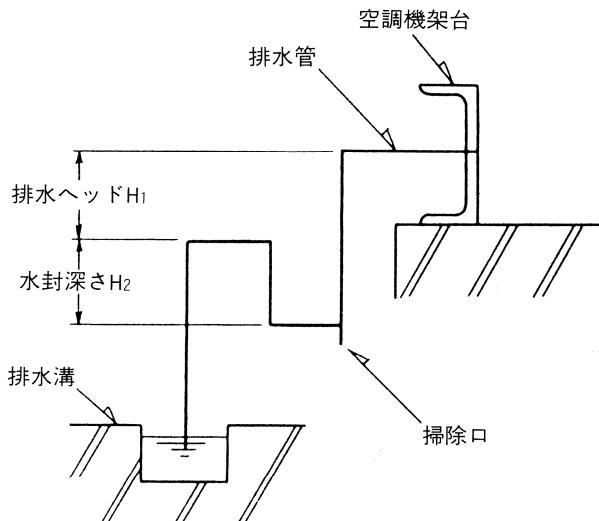
$H_1 >$  ファン静圧、並びに  $H_2 >$  ファン静圧となるように施工してください。
